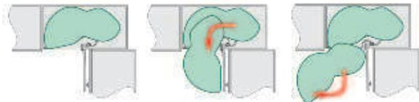
Nota: la salida de las bandejas es modificable mediante un dado de regulación debajo de las mismas.
